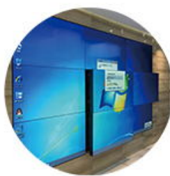
前维护支架安装
